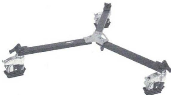
O Manfrotto **114MV Cine / Video Dolly** é projetado para uso com tripés com os pés cravados. Esta dolly recursos travada individualmente 5 "rodas com guardas de cabo e um sistema de bloqueio de perna única. Apuramento Entrada necessária para a Dolly totalmente montado é de apenas 44,1".
